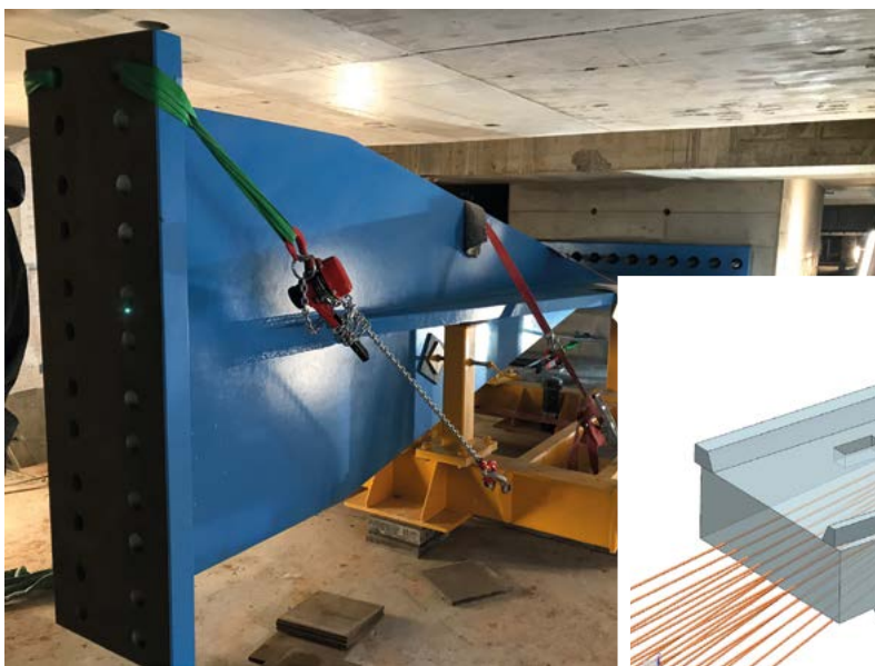
LÄNGSKRAFTABTRAGUNG über die doppelt verschränkte Federlamelle
