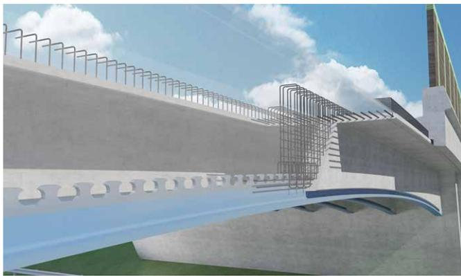
**Bild 2** Visualisierung der Anwendung von Verbunddübelleisten als externe Bewehrung bei einer Autobahnüberführung
