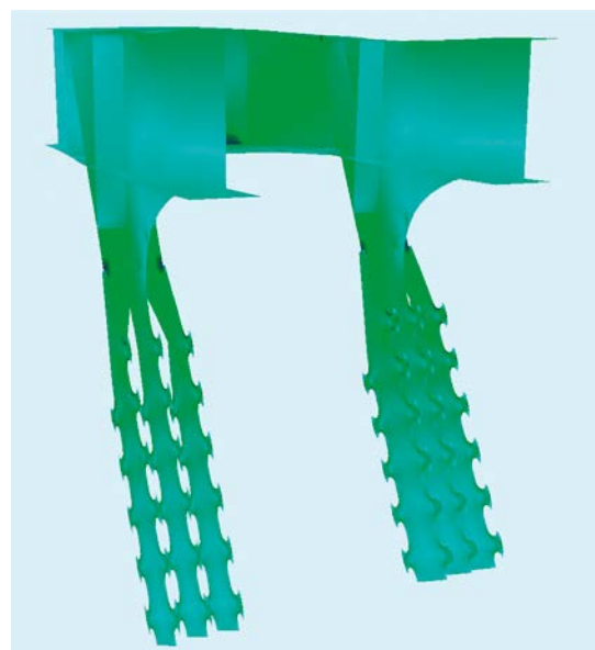
Bild 17. FE-Modell zur Berechnung der Verankerungskonstruktion
