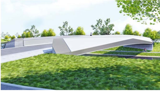
Bild 8. Blick auf die Mayereinödbrücke mit den verschränkten Obergurten der Stahlhohlkästen
