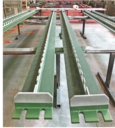
Bild 10. Stahlträger mit Verbunddübelleiste und fertigem Korrosionsschutz vor der Ergänzung der Betonfertigteilplatte Fig. 10. Steel girders implementing the composite dowel strip and completely coated before casting the prefabricated concrete plate
