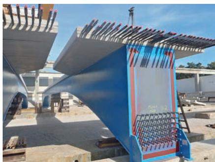
Bild 16. VFT-Hohlkästen im Fertigteilwerk der Fa. Max Bögl (© Max Bögl)
